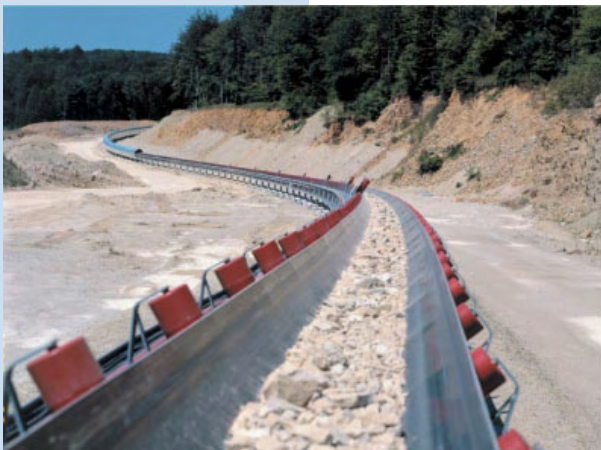
Abb. 1 - Kalksteintransport durch kurvengängigen Gurtförderer.
