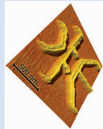
Mit dem Rasterkraftmikroskop erzeugter Quantenpunkt (Quelle: Haug/FKP)
