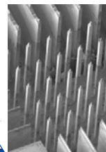
Bearbeitung durch Trepannschleifen
