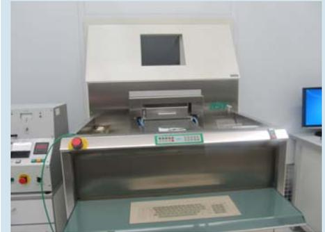
Es handelt sich hier um zwei vom MBE selbst gebaute RTPs. Das rechte System ist für Temperaturen bis etwa 950°C und zum Tempern von Metallen geeignet, das Linke bis 1100°C, saubere Wafer (keine Metalle). An beiden Geräten sind die Gase N<sub>2</sub>, Ar, O<sub>2</sub> und N<sub>2</sub>H<sub>2</sub> verfügbar.
