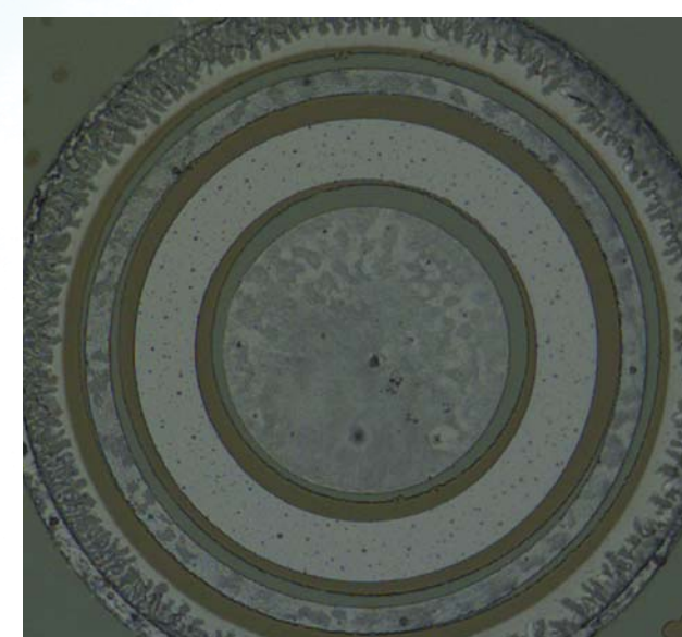
Transistor-Struktur von Aluminium-Ringen auf Germanium (Grün) mit Tantalnitrid-Zwischenschichten (Braun). (R. Kaiser, MBE und LNQE)
