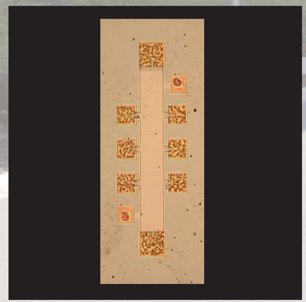
Hall-Geometrie für Messungen in zweidimensionalen Elektronensystemen (L. Bockhorn, FKP)
