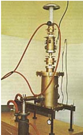
Das erste zweistufige Elektronenmikroskop, konstruiert von Knoll and Ruska (1931)
